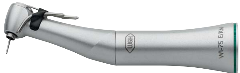
WI-75 E/KM 20:1, Druckknopfspannung, für chirurgische Bohrer und Fräser mit Winkelstückschaft \varnothing 2,35 mm [Schafthärte >50 HRC, >520 HV], Innenkühlsystem Kirschner/Meyer und Spray extern Indikation: z. B. Implantation
