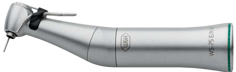
WS-75 E/KM 20:1, Druckknopfspannung, für chirurgische Bohrer und Fräser mit Winkelstückschaft \varnothing 2,35 mm [Schafthärte >50 HRC, >520 HV], Innenkühlsystem Kirschner/Meyer und Spray extern Indikation: z. B. Implantation, Osteosynthese, Segmentosteotomien
