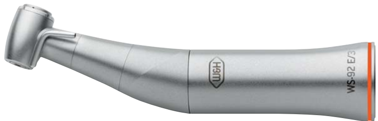
WS-92 E/3 1:2,7, Druckknopfspannung, für chirurgische Bohrer und Fräser mit FG-Schaft \varnothing 1,6 mm, 3-fach Spray extern Indikation: z. B. Hemisektion, Weisheitszahnentfernung
